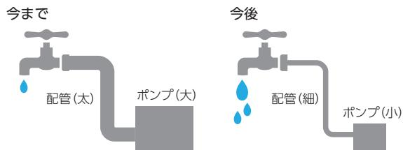
配管に成膜加工をすることにより、「配管の水が流れやすくなる」、「保護膜により配管の腐食を防止する」などの機能向上が期待できます。また、流体抵抗の低減によってポンプの小型化(省電力化)や水道管の小径化により生活インフラに大きな影響を与えられる技術だと期待しております。
