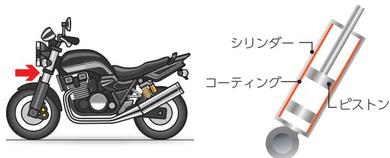
細管やチューブなどにコーティングを施すことにより、カテーテルなど高機能医療機器に応用することや、摺動性の向上によって、車両や産業機械向けの配管やシリンダーパイプの高機能化・小型化に応用することが可能となります。
