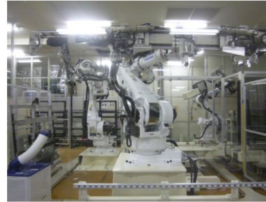
基板着脱工程の自動化 2
