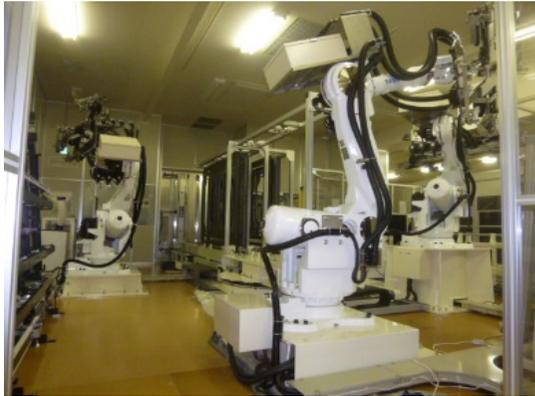
基板着脱工程の自動化 1
